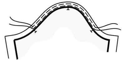
Die erste Stichlinie sollte 0,1 mm über der markierten Stichlinie platziert werden, die zweite Stichlinie sollte 0,5 mm über der ersten Stichlinie platziert werden. (Siehe Abbildung 1)
